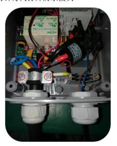
▶ 如图所示用十字螺丝刀、7号套筒或开口扳手拧开红色圆圈标注处的固定螺丝,再将箭头所指红色CP线于右图红圈标记处端子上拆出。
