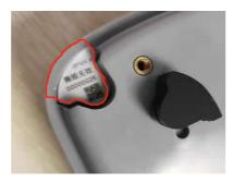
充电桩本体安装螺丝孔处贴有保修防拆标签,非授权拆开将失去保修资格。授权人员如需进行开箱操作,需要在操作完成后,重新贴我司授权的保修防拆贴纸,并在维修单记录贴纸追踪号码。
