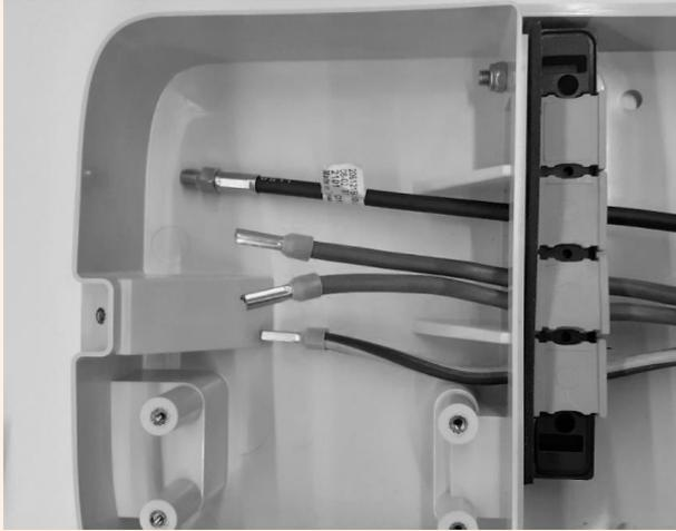
10. Befestigen Sie den Dichtungsblock an der Basis, indem Sie die Mutter mit einem 8-mm-Schlüssel festhalten und die Schraube mit einem 4-mm-Sechskantschlüssel anziehen (siehe Schritt 5).
