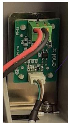
Anschlusskabel für die Motorsteuerung
