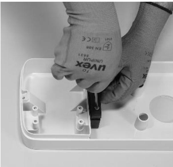
4. Identifizieren Sie die Schraubenmuttern, mit denen der Dichtungsblock befestigt ist. Halten Sie die Mutter mit einem Schraubenschlüssel der Größe 8 fest und lösen Sie dann die Schraube mit einem Sechskantschlüssel der Größe 4.
