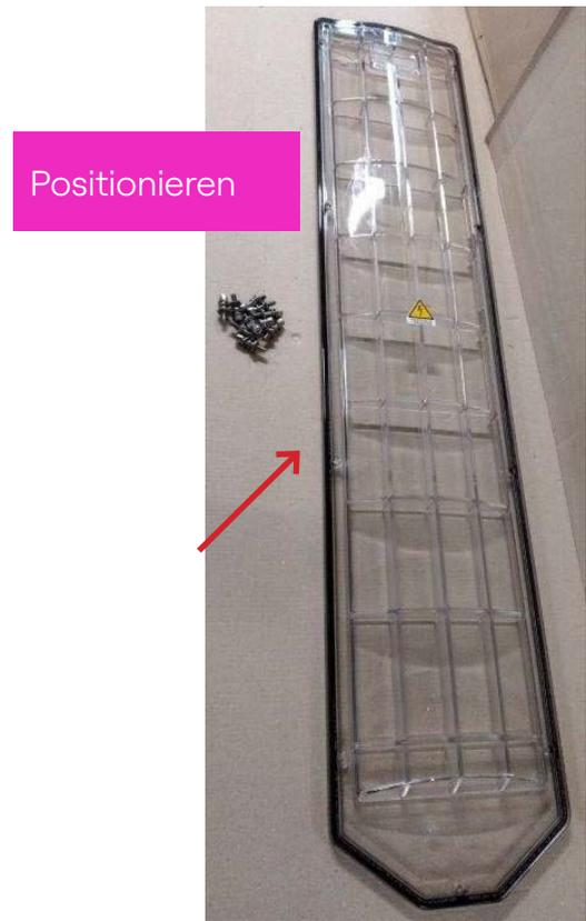
Schrauben Sie den Lexanschutz der Klemmleiste ab und legen Sie ihn mit den 2 Schrauben an einen sicheren Ort.
