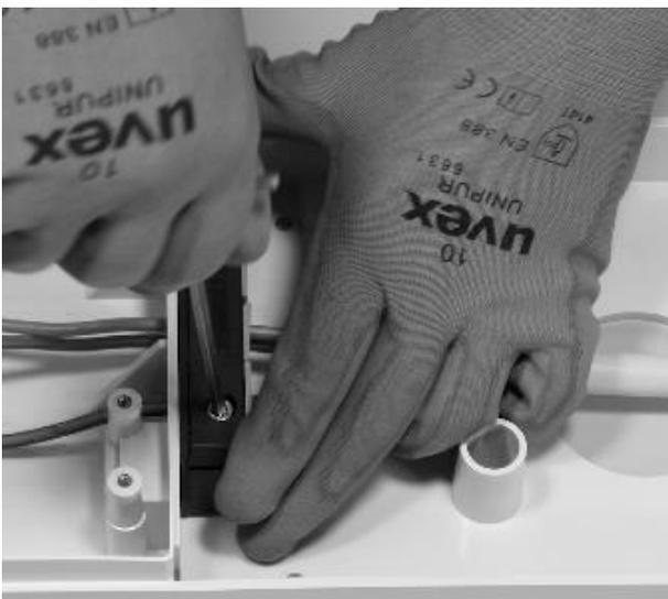
12. Installare la ferrite intorno ai cavi di alimentazione alla base del blocco guarnizioni.
