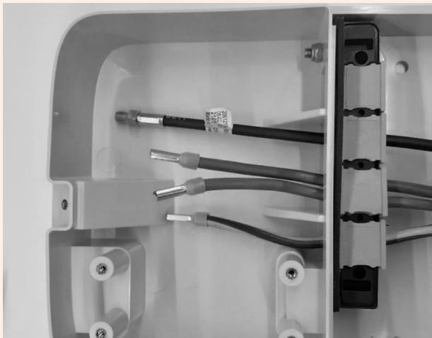
10. Fissare il blocco guarnizioni alla basetta, utilizzando una chiave da 8 mm per tenere fermo il dado e al contempo serrare la vite con una chiave esagonale da 4 mm (vedere il punto 5).
