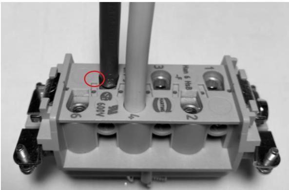
14. Eseguire una prova di trazione per controllare che i fili siano saldi.
