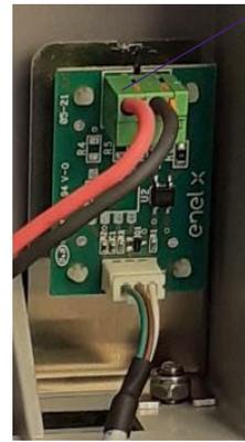
Cavi di connessione per il comando del motorino
